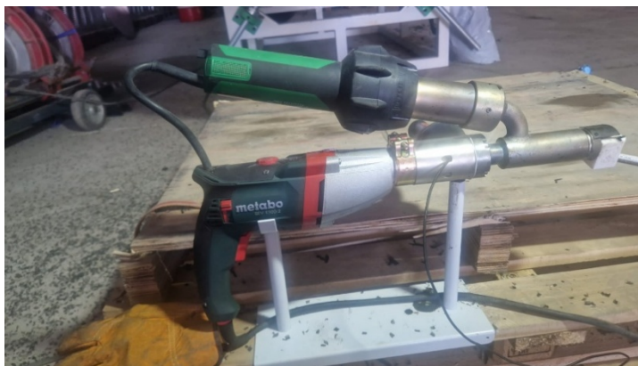
3-сурет – Қолдық дәнекерлеу экструдері
