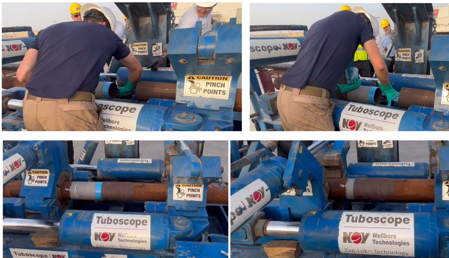
10-сурет – Сұйық эпоксидті майлағышты жағу және құбыр ұштарын біріктіру
