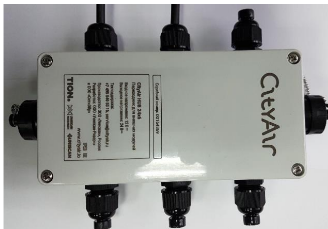
6-сурет -Сыртқы модульдерге арналған адаптер
